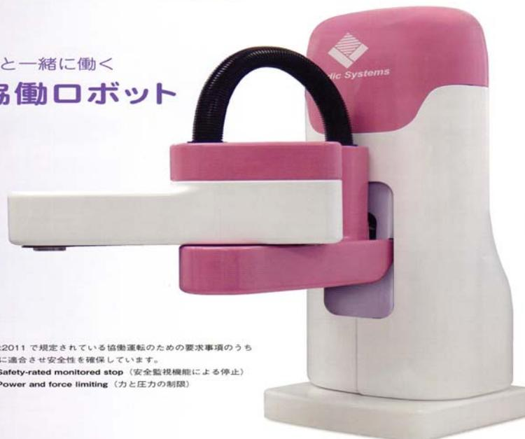
ISO 10218-1:2011 で規定されている協働運転のための要求事項のうち下記の二項目に適合させ安全性を確保しています。
